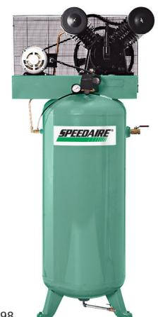
Compresor Estacionario de Una Etapa, 5.0 HP. Cuenta con bomba de hierro fundido lubricada por aceite. Tiene un ciclo de servicio 80/20 para aplicaciones en general que requieran de una mayor presión.
